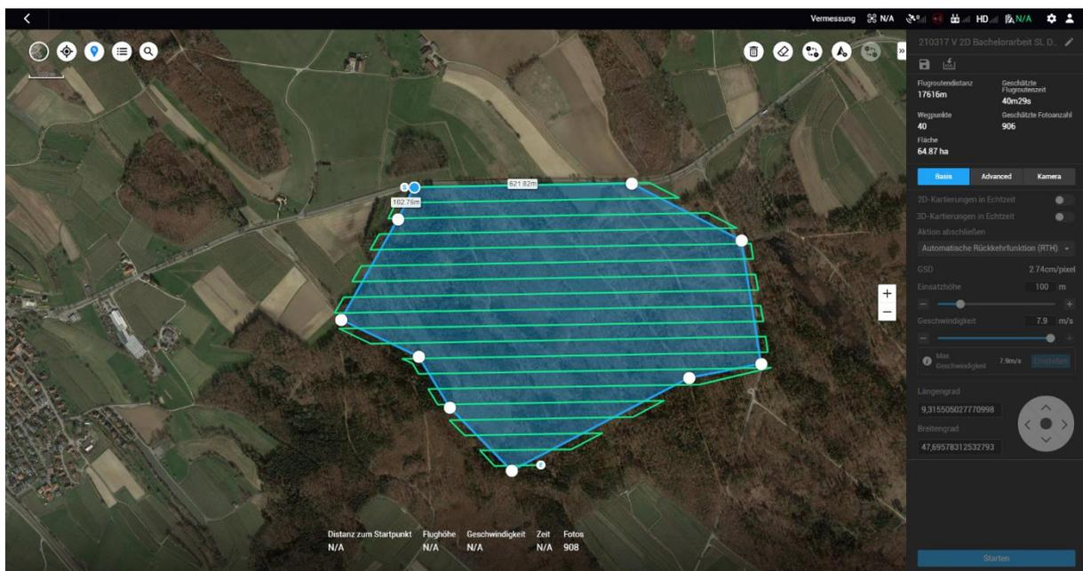
Abbildung 2: DJI Terra Flugroutenplanung (eigene Darstellung)
